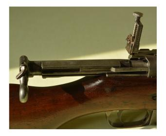
Sopra la camera di cartuccia, oltre alla scritta del fabbricante troviamo i punzoni "L" e "C", che significano letteralmente "Large Chamber", ovvero camera di cartuccia larga; questo significa che la camera di cartuccia è stata alesata in arsenale per permettere l'utilizzo di munizioni con tolleranze più larghe (colpi di fabbricazione britannica del periodo bellico), come accennavo all'inizio della scheda. Notiamo anche la presenza dei punzoni "British proof" sia sulla canna che sulla culatta.
